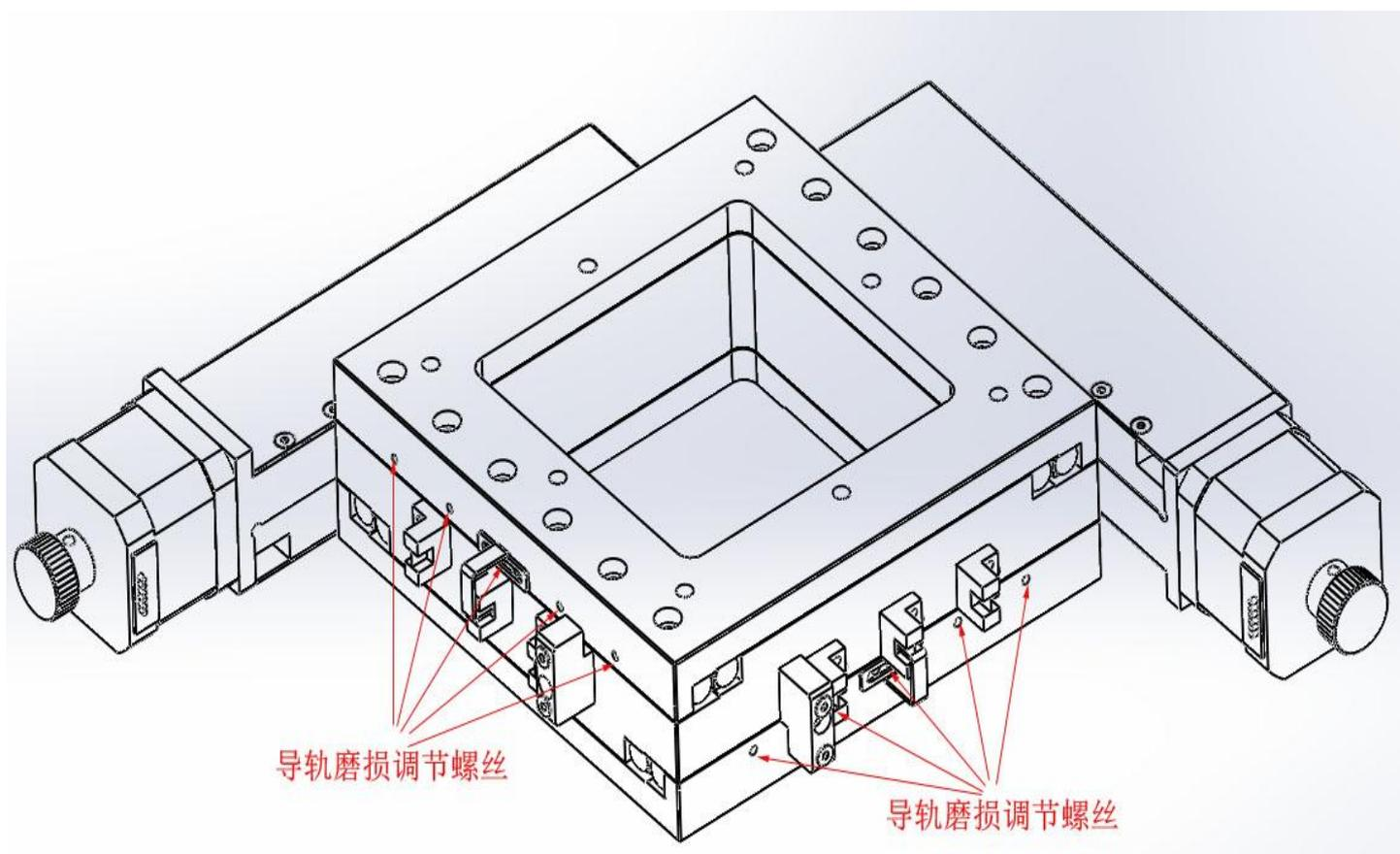
由于导轨的磨损, 当滑台长期使用后产生了侧向间隙, 可通过滑台侧边的交叉导轨间隙调整螺丝预紧使间隙消除。
