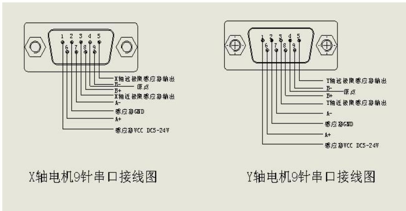
X轴电机9针串口接线图
