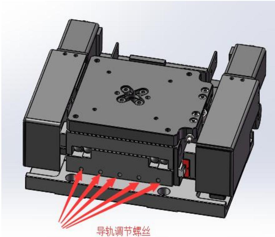
由于导轨的磨损, 当滑台长期使用后产生了侧向间隙, 可通过滑台侧边的交叉导轨间隙调整螺丝预紧使间隙消除。
